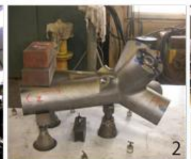
□1. 鉄骨柱を複雑な角度で組むために鉄骨工場では組立用のフレームを作り製作の精度管理をしている。2. 6本の部材が交差する部のジョイント。3.4本の部材を工場接続し現場に搬入する。4. 鉄骨柱や梁と接続するための金具(キャスト)
