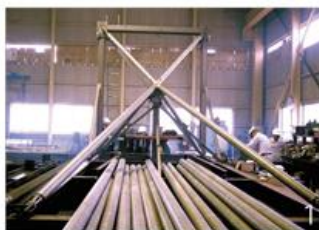
□1. 鉄骨柱を複雑な角度で組むために鉄骨工場では組立用のフレームを作り製作の精度管理をしている。2. 6本の部材が交差する部のジョイント。3.4本の部材を工場接続し現場に搬入する。4. 鉄骨柱や梁と接続するための金具(キャスト)
