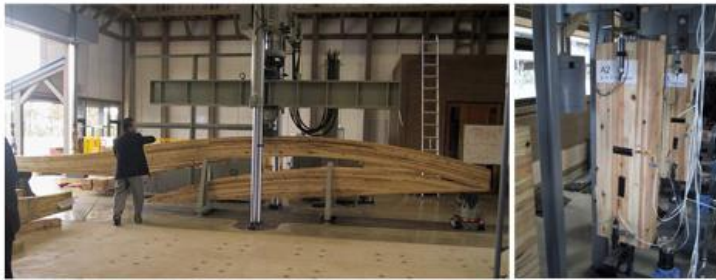
□実大の強度確認実験(左)とクリープ実験(右)共に宮崎県木材加工センターで行った
